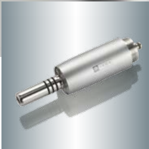
Micromoteur sans balais i-XS4 Pour les interventions classiques de l'odontologie conservatrice, prothétique et d'endodontie, ainsi que pour la chirurgie. Valeur de couple jusqu'à 70 Ncm pour l'implantologie avec un contre-angle approprié. Plage de vitesse de 100 à 40 000 tr/mn.
