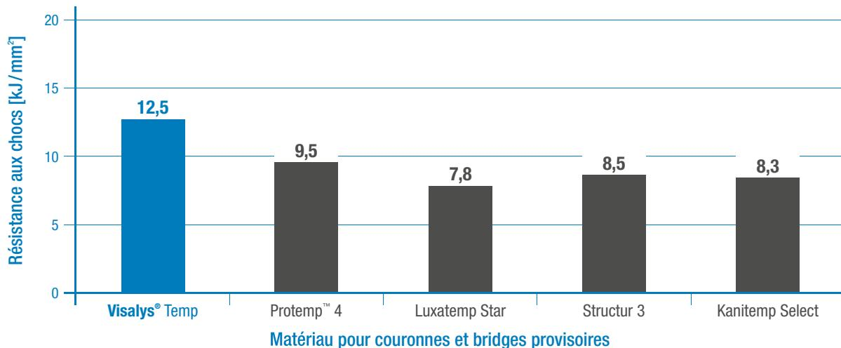
Mesures de l'Université d'Erlangen, conformément à la norme DIN EN ISO 179, DIN 53453
