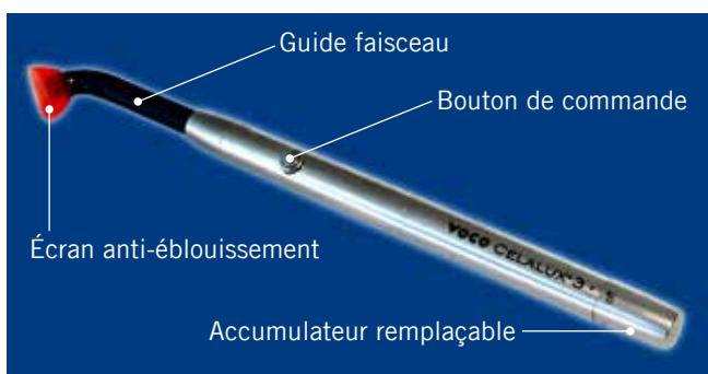
Un accumulateur entièrement chargé permet de réaliser sans problème 45 cycles de polymérisation de 20 secondes chacun. Pour recharger un accumulateur vide, il vous suffit de le retirer de la pièce à main de l'appareil et de le placer dans la base de chargement. Entre-temps, le second accumulateur fourni avec la lampe vous permettra de poursuivre votre travail.
